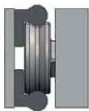
Широкая направляющая с внутренним расположением роликов каретки
